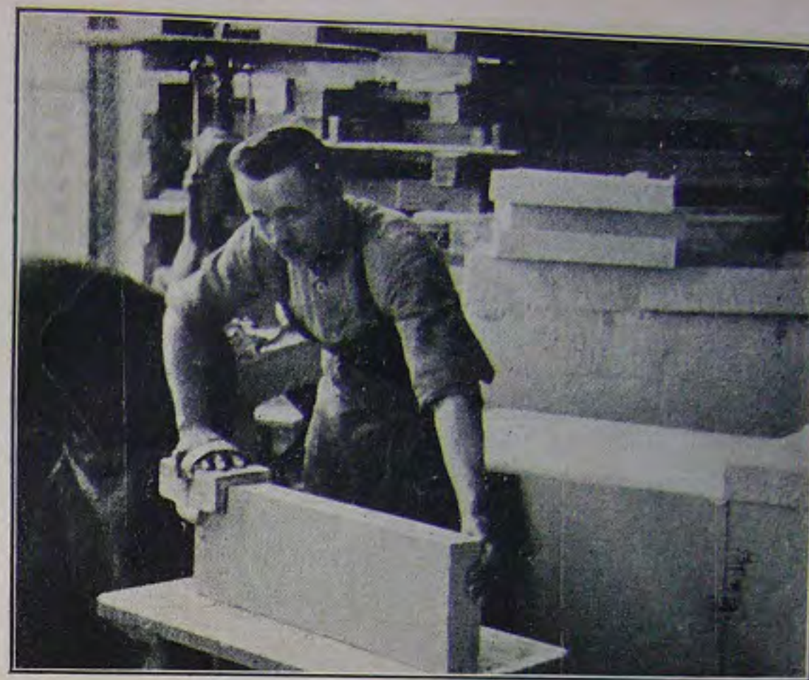
Schneiden großer Seifenplatten in einzelne Riegel.
