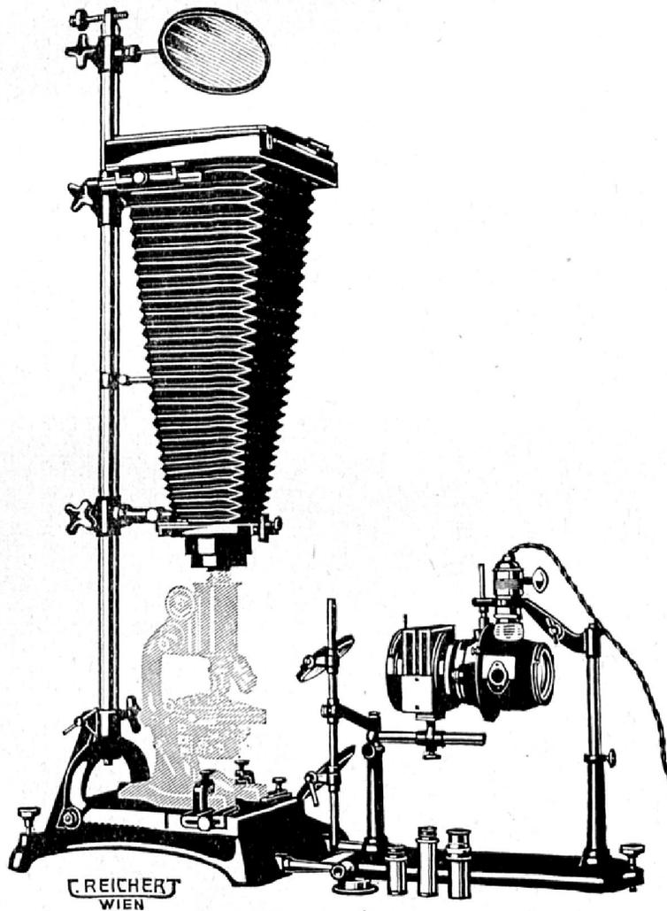
Abb. 2. Mikrophotographische Universalapparatur von C. Reichert.
