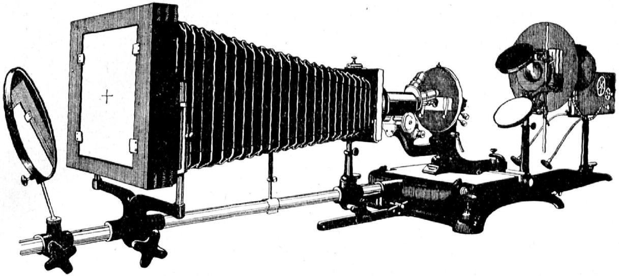
Abb. 1. Mikrophotographische Universalapparatur von C. Reichert.
